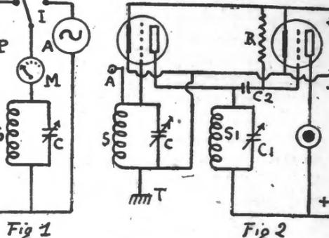
Le montage de la résistance-capacité que nous connaissons, qui réunit la plaque au positif de la batterie de plaque est destinée à laisser passer le courant continu et, au contraire, à bloquer l'alternatif et à l'envoyer, à travers le petit condensateur, dans la grille de la lampe suivante.
