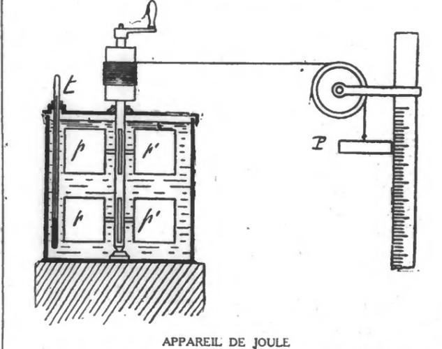
APPAREIL DE JOULE La chute du poids P fait tourner la manivelle et les palettes p p'. Le frottement des palettes dans l'eau ralentit la chute du poids, cette perte de «force vive» se retrouve dans l'augmentation de température de l'eau du récipient. On mesure l'élevation de la température au moyen du thermomètre t.
