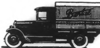
Moteur 12 CV. Châssis très robuste pouvant supporter jusqu'à 2 tonnes pour service de ville ou terrain peu accidenté.
