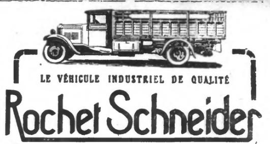
LE VEHICULE INDUSTRIEL DE QUALITE. 7 modèles avec moteur à essence 4 et 6 cylindres, pour charge utile de 1.800 à 6.000 kgs.
