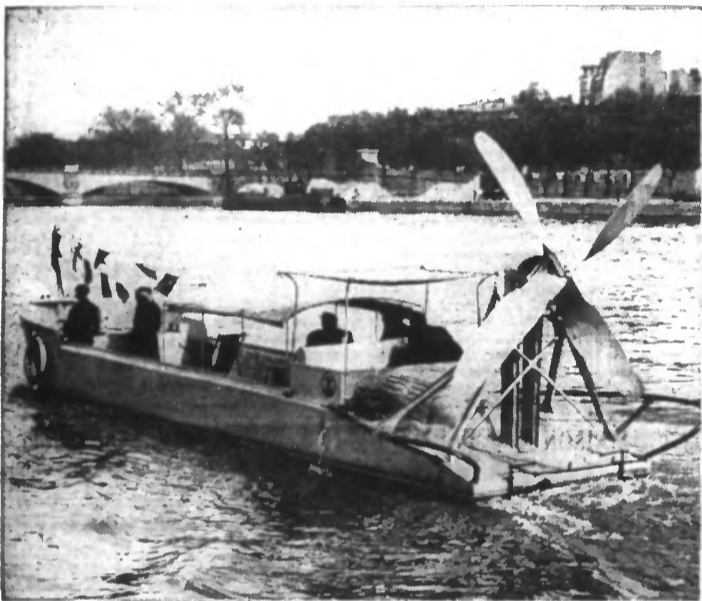
Le chaland à hélice aérienne, construit spécialement pour les colonies, est présenté au Salon nautique. (Photo Trampus)
